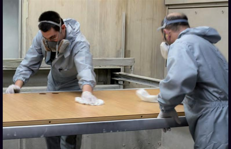
*Um Transparenz und Langlebigkeit von Holzoberflächen zu erzielen, massieren wir eine spezielle Grundierung per Hand tief in die Poren des Holzes ein. Erst danach wird die Oberfläche mehrfach lasiert.*
